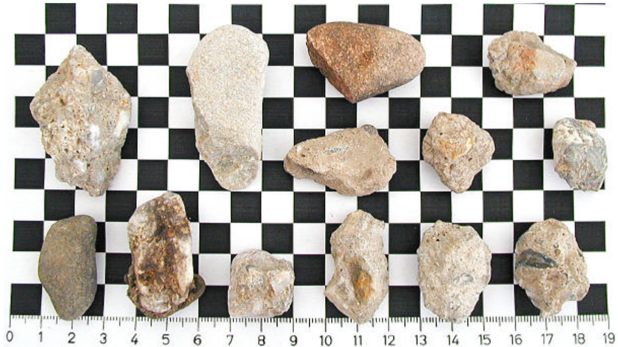
Abbildung 2: Abmessungen der größten Körner des Kies-Sand-Gemisches für die Verschmutzung der INTEWA Wechselsprungfilter (Rasterweite 1,0 cm)
